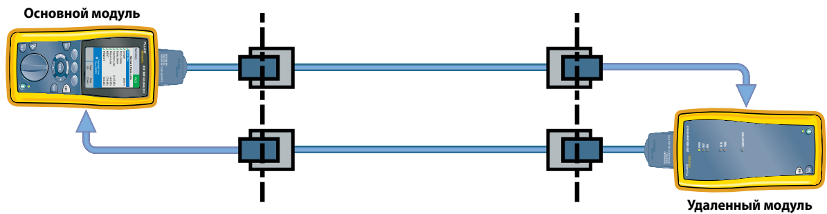
Рис. 4: Альтернативный метод измерений Alien FEXT при тестировании горизонтальной кабельной системы при отсутствии дополнительной коммуникационной линии для синхронизации.
